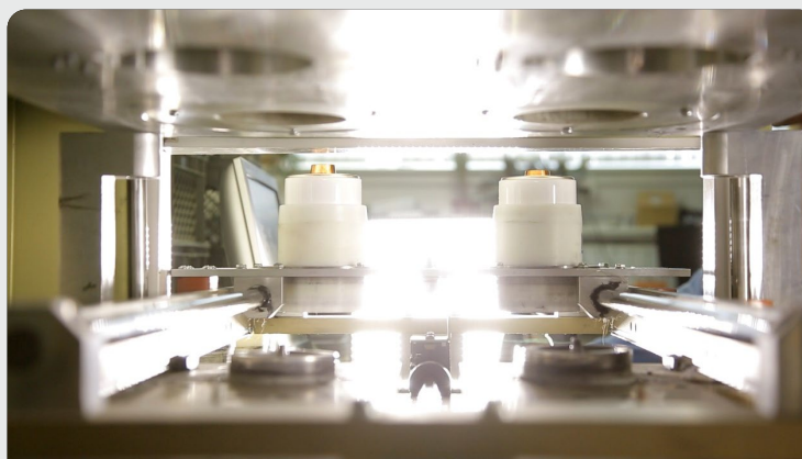
Установка для проведения прямо-сдаточных испытаний ВДК
