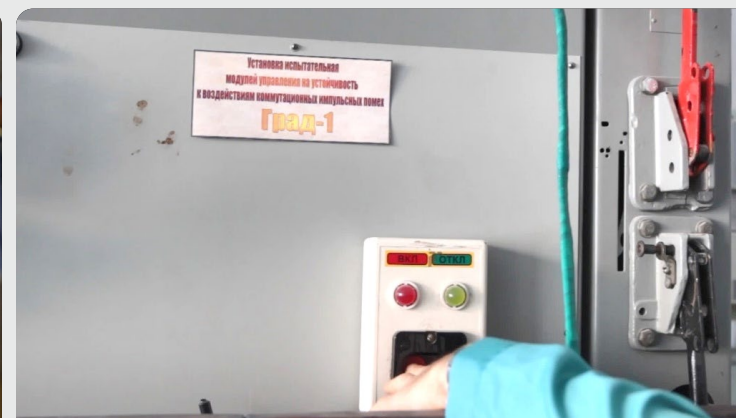
Генератор импульсных помех для проверки модулей управления на ЭМС
