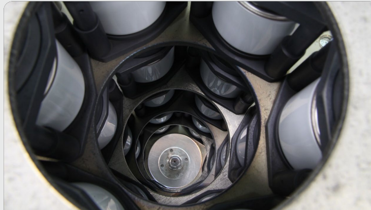
Вакуумные печи для изготовления ВДК по принципу Single-Shot
