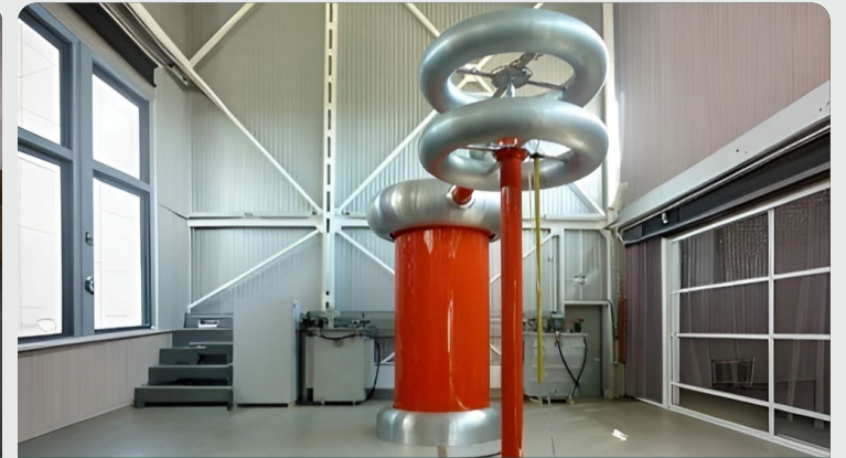
Генератор повышенного напряжения промышленной частоты до 330 кВ
