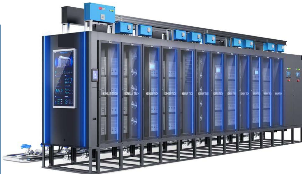
Вычислительный модуль с воздушным охлаждением (1/2 SU-16 узлов)
