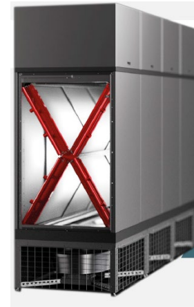
2-х СЕКЦИОННЫЙ КОНДИЦИОНЕР НА ОХЛАЖДЕННОЙ ВОДЕ. Х-ОБРАЗНЫЙ ТЕПЛООБМЕННИК. НИЖНЯЯ ПОДАЧА. Для работы с высокими температурами и высокой дельтой . Отдельная секция с ЕС-вентиляторами под полом.
